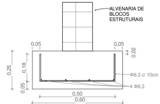
DEVERÁ SER FEITA A COMPACTAÇÃO DO SOLO DA BASE DO CORTE ONDE DEVERÁ SER EXECUTADA A SAPATA
