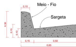
Sargeta e Meio Fio conjugado, de Concreto Simples FCK = 15MPa Pré-Moldado, Conforme item EMOP 08.027.0051-A e 08.027.0054-A.
