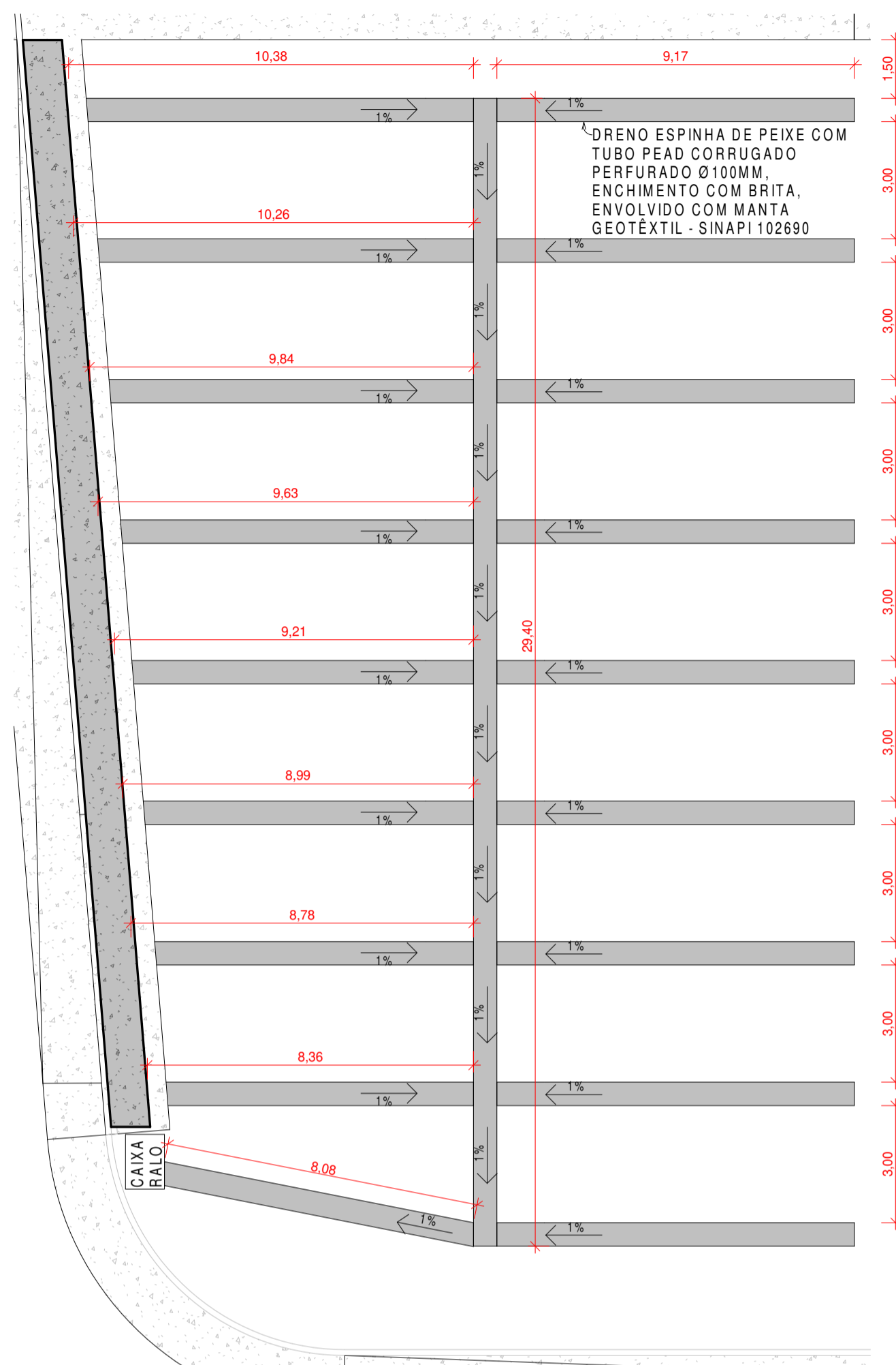
1 DRENAGEM ESPINHA DE PEIXE ESCALA 1:120
